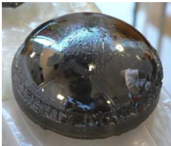
Monokryształ węgliku krzemu z LMGP (Minatec) w Grenoble, Francja, fot. David Monniaux/Wikipedia/CC-BY-SA-2.5
